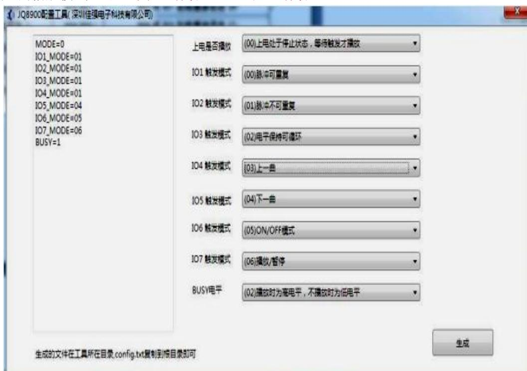
对每个 IO 口进行配置好后，点生成，就自动在配置工具所在目录生成一个 config.txt 文件，然后将 config.txt 文件复制到播报器所在的 U 盘即可更新参数。
