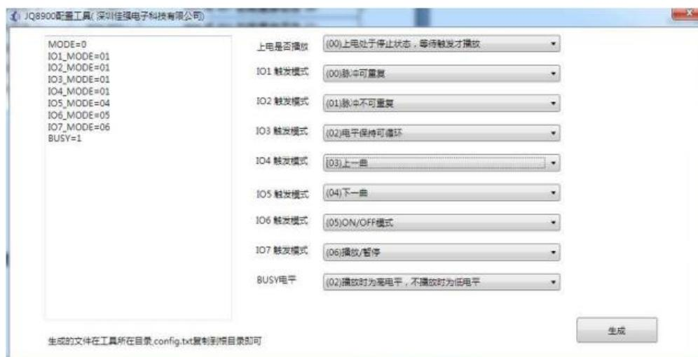
对每个 IO 口进行配置好后，点生成，就自动在配置工具所在目录生成一个 config.txt 文件，然后将 config.txt 文件复制到控制器所在的 U 盘即可。
