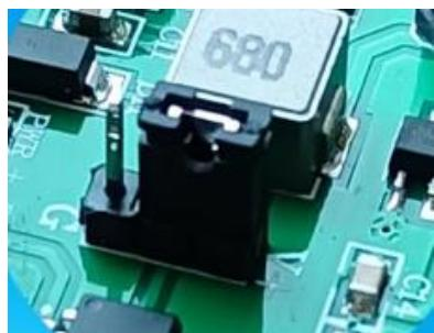
内部跳线短接 V：外部输入开关低电平触发语音播放
